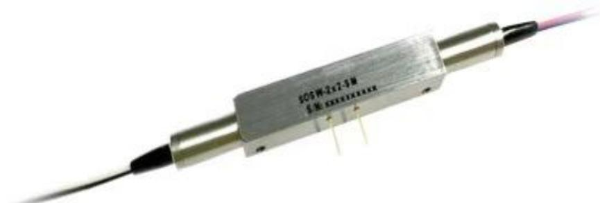
2x2 开关是全固态开关设备，没有任何移动部件。光的切换是利用法拉第效应实现的。这是通过专利保护的非机械配置和固态全晶体设计实现的，无需机械运动。微秒光纤开关旨在满足可靠性、耐用性、快速响应和连续高频切换操作等最苛刻的切换要求。
